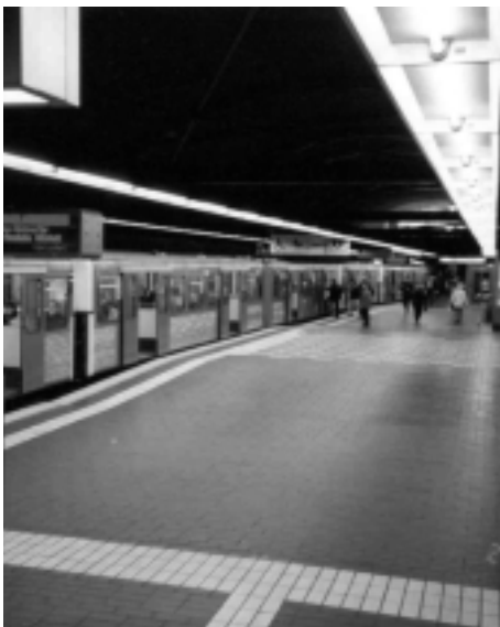
Die Zugänglichkeit des Zuges kann durch eine Erhöhung des für Rollstuhlfahrer vorgesehenen Bahnsteigabschnitts verbessert werden (Hamburg)
